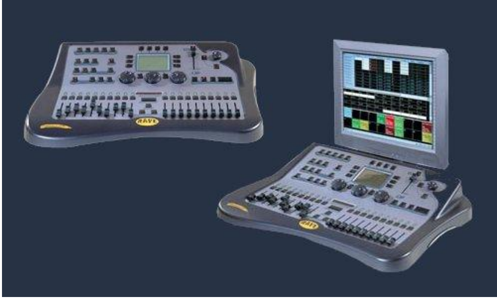
Resim 3.8: Işık kontrol paneli
