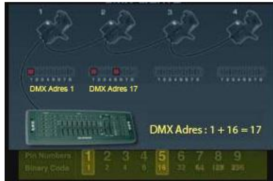
Resim 1.18: DMX uyumlu cihazların DMX adres pinlerinin ayarlanması
