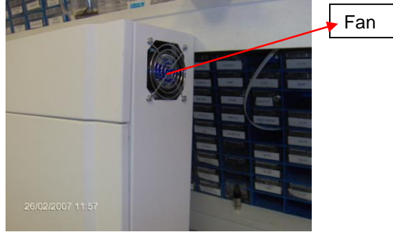
Resim 2.3: Cihaz içindeki fanın montaj görünüşü
