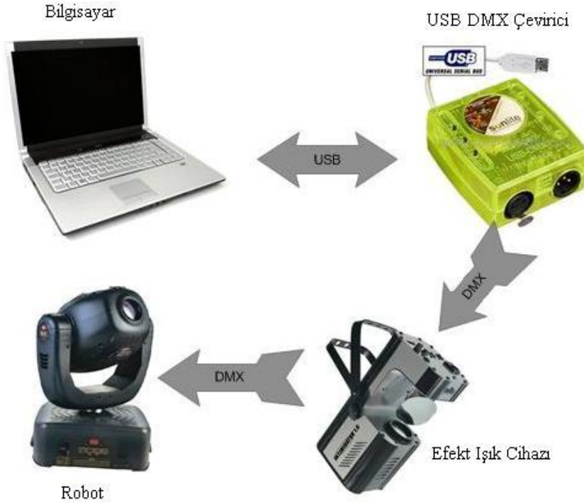
Resim 1.4: Işıklandırma sisteminde kullanılan cihazların bilgisayar bağlantısı
