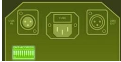
Resim 1.16: DMX uyumlu cihazların DMX adres pinleri
