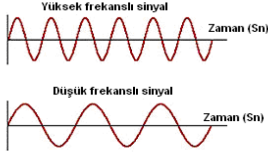
Şekil 1.3: Yüksek frekanslı sinyal ile düşük frekanslı sinyalin karşılaştırılması
