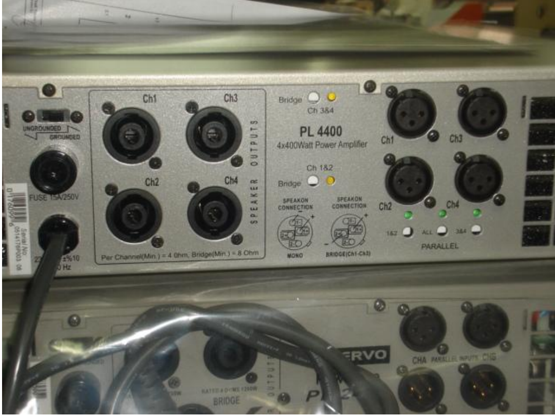
Resim 2.2: Amplifikatöre ait giriş çıkışlar
