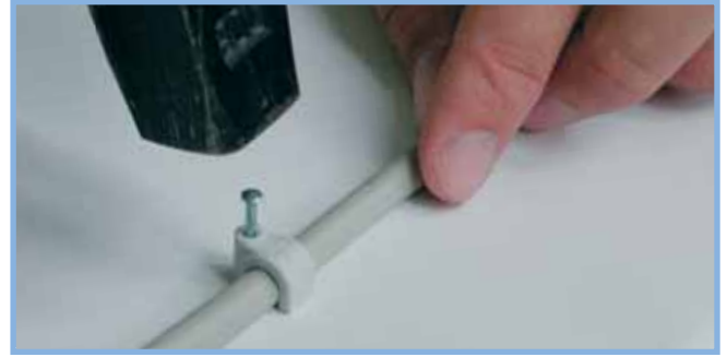
Kablolari hızlı ve güvenli bir şekilde neredeyse her duvara sabitlemenin kolay yolu.
