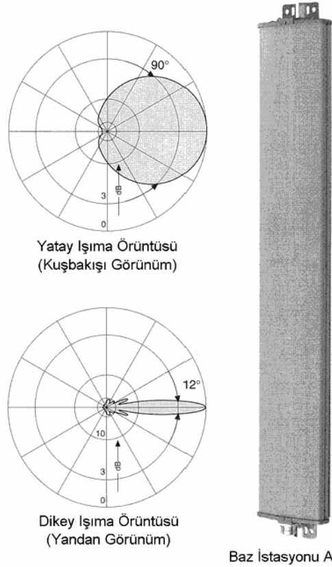
Şekil 7. GSM baz istasyonlarında kullanılan tipik antenlerin ışınım örüntüsü örneği
