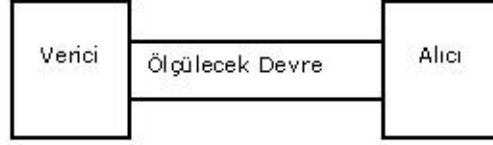
Şekil 2.8. Zayıflama Arızasının tespiti
