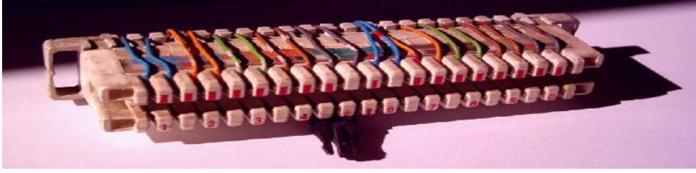
Resim 1.5: Prensibal kabloların renk kodlarına göre modüllere irtibatlandırılması
