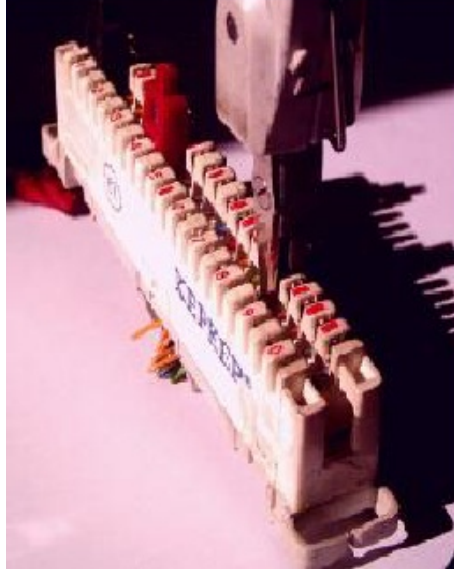
Resim 4.32: Krone bıçağı ile modüle kablo irtibatlama
