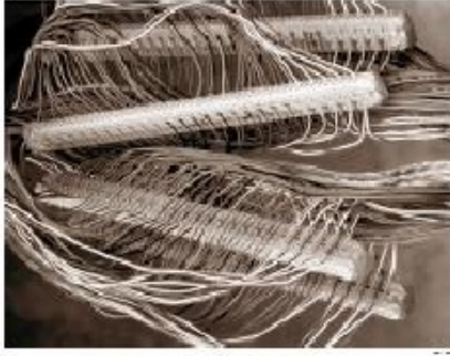
Resim 4.50: Bağlantısı tamamlanmış 25 perlik iletken gurubu ve 25 perlik modül parçaları
