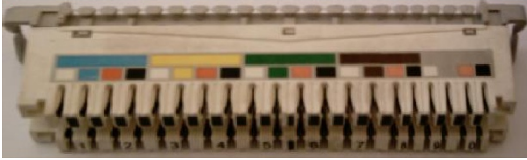
Resim 2.8: Modül üzerinde görülen renk sıralaması
