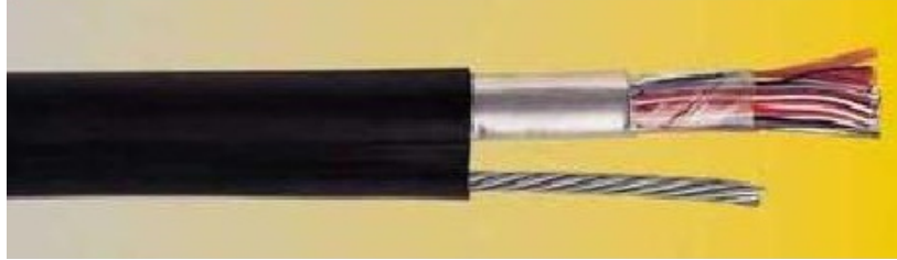
Resim 2.5: Havai tip askı telli telefon kablosu KPD-AP-A
