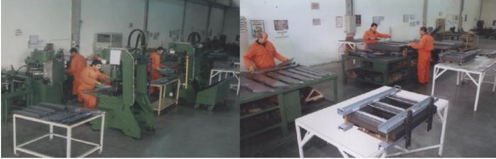
Resim 1.1: Nüve saclarının hazırlanışı
