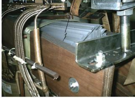
Resim 1.7: Üretim hata kaynaklı nüve
