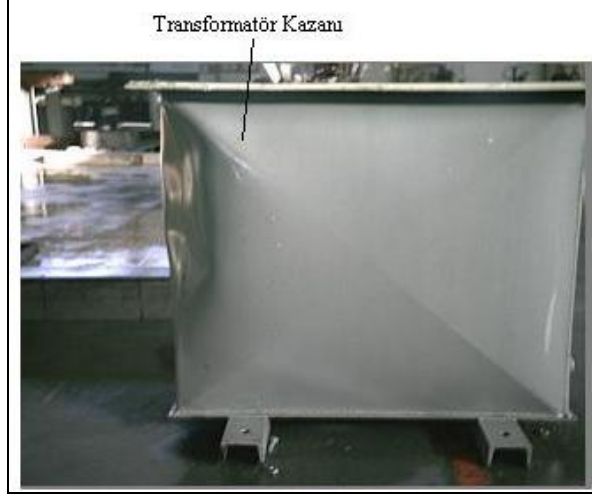
Resim 1.11: Deforme olmuş trafo kazanı
