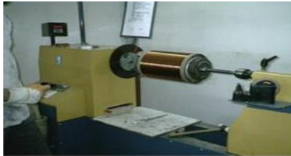
Resim 2.3: Sarımı yapılan trafo bobini
