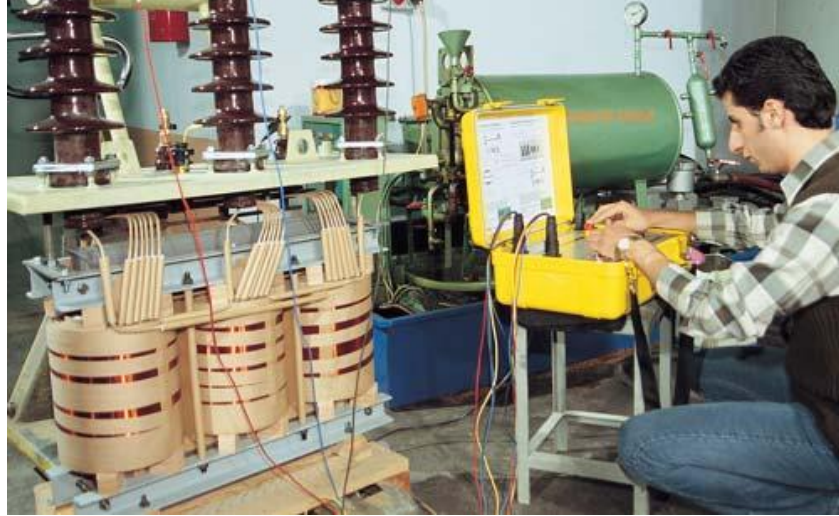
Resim 2.7: Transformatör sargılarının test edilmesi
