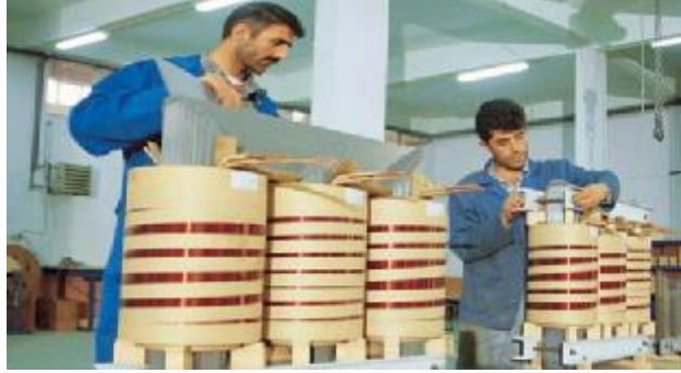
Resim 2.5: Sargıların nüve yerleştirilmesi ve nüvenin bağlantısı
