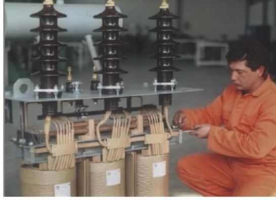
Resim 2.6: Yalıtımı ve bağlantıları tamamlanmış OG / YG transformatörü
