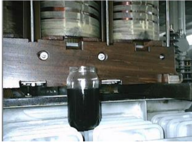
Resim 1.8: Görünümü ve kokusu değişmiş trafo yağı
