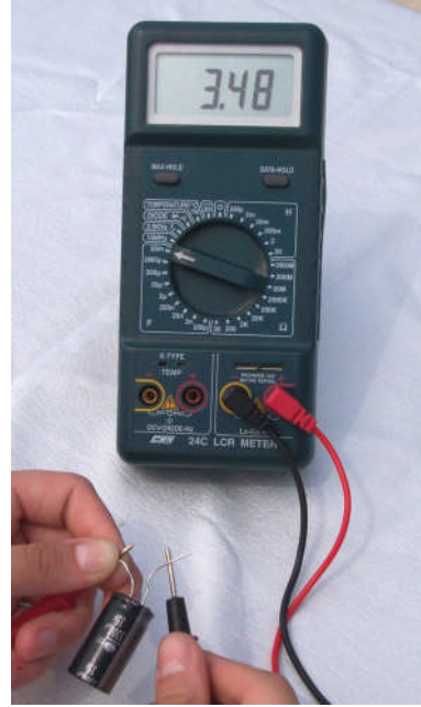
Resim 4.1: Avometre ve Lcrmetre ile kapasite ölçümü
