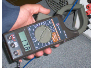
Resim 5.4: Pens ampermetre ile akım ölçmek
