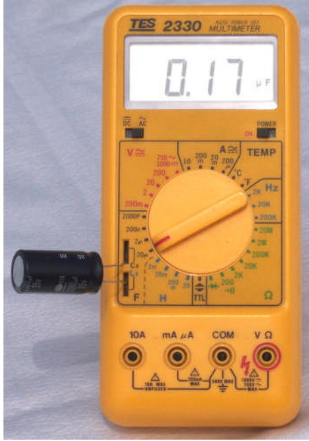
Resim 4.1: Avometre ve Lcrmetre ile kapasite ölçümü
