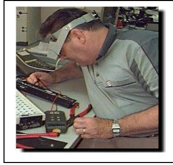
Resim 1.23: Başlık ve Bilezikle Vücuttaki Statik Elektrik Topraklanması
