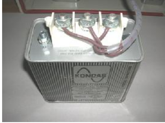
Resim 2.3: Üçgen bağlı bir kondansatör gurubu
