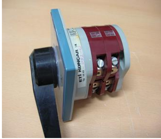
Resim 1.4:AG kompanzasyonunda kullanılan bir paket şalter
