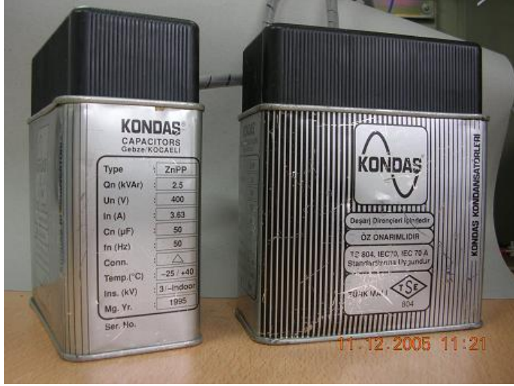
Resim 2.2: Deşarj dirençleri içerisinde olan 2,5 Kvar'lık bir kondansatör
