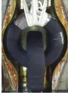
Resim 1.3: Reçine kalıbına yerleştirilmiş bir gerilim transformatörü
